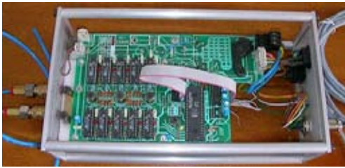
Şekil 4. Tanı sisteminde kullanılan Elektronik Burun
