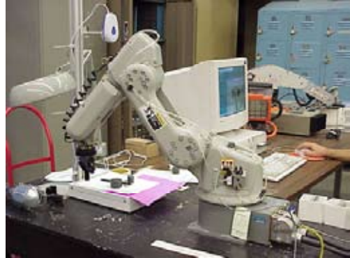
Şekil-1, Bilgisayar Kontrollü Endüstriyel Robot.
