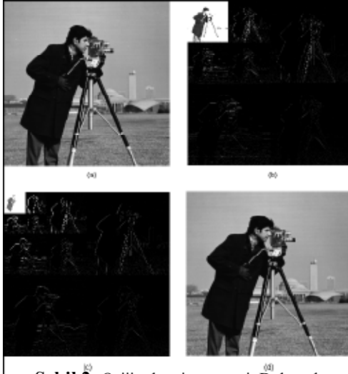
Şekil 2: Orijinal resim, ona ait Dalgacık dönüşümleri ve orijinal resmin geri oluşturulmuş hali
