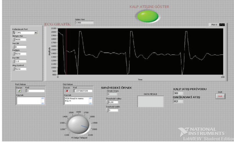
Şekil 18. Labview kullanıcı ara yüzü ve alınan analog sinyal
