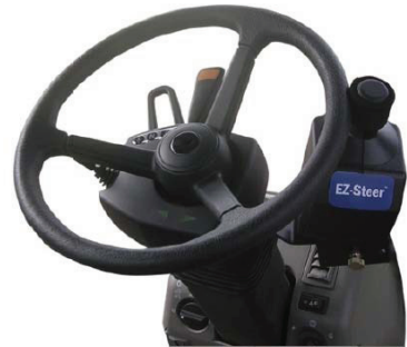
Şekil 6. Elektrik motoru ile direksiyon kontrolü (Trimble, 2005).
