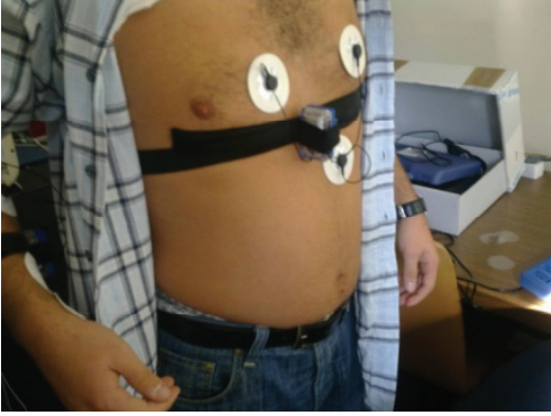
Şekil 6 Göğüse takılan SHIMMER düğümü (EKG kipi).
