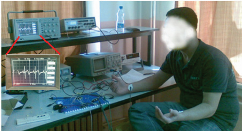
Şekil 4. Prototip EKG devresinin test edilmesi
