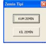
Şekil 6. İksa hesabı için zemin tipi seçimi
