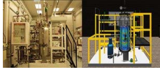
Şekil 3. Fermantasyon İşleminin Sanal Ortamda Üç Boyutlu Modeli
