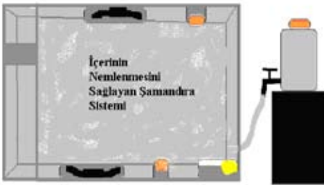
Şekil 3. Kuluçka Makinesinde Kullanılan Nem Düzeneği
