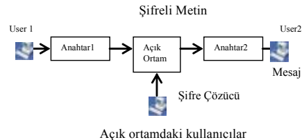
Şekil 3. Bir mesajın dinlenmesini önlemek için anahtar kullanımı (13)
