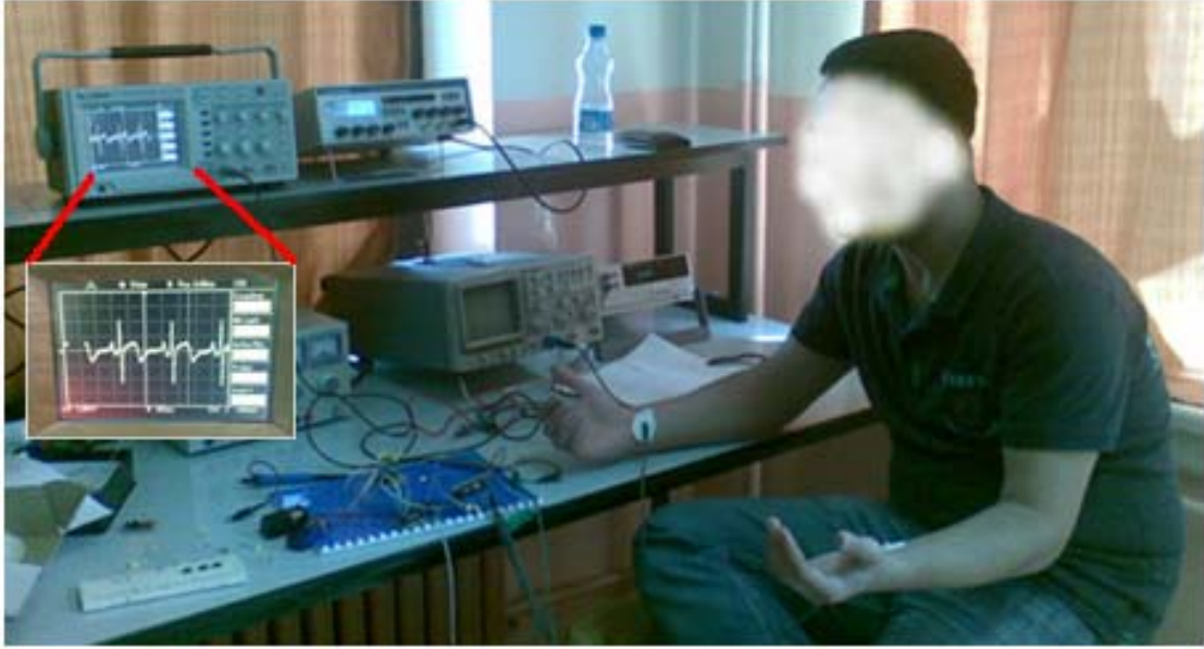
Şekil 4. Prototip EKG devresinin test edilmesi
