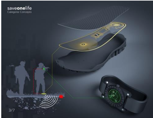
Şekil 12. SaveOneLife giyilebilir mayın detektörü
